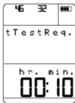
用空气测试的测试压力、压力下降和测试时间
